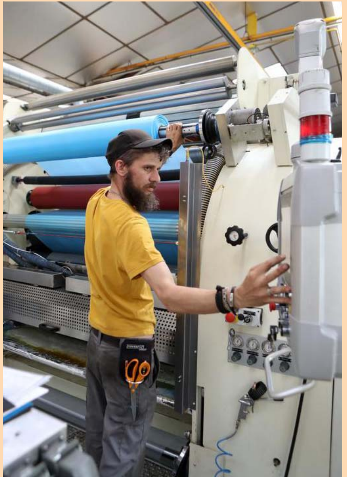
Le contrecollage permet d'associer durablement des matériaux entre eux et d'ajouter leurs propriétés. Photos Jérôme BRULEY
